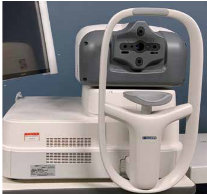
図1 当院の前眼部 OCT (CASIA2: トーメーコーポレーション) 被験者は顎台に顎を乗せ、額を枠につけて顔を固定して撮影する。
